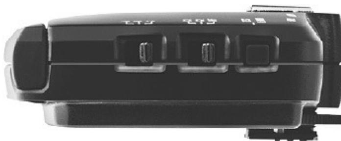
**3.** Для каждой из задействованных ведомых групп задайте ручной (M) или автоматический (A) режим работы при помощи переключателей модуля AC3. Посредством поворотных дисков задайте для групп настройки мощности (черные цифры на белом фоне обозначают увеличение мощности на соответствующее число ступеней, белые цифры на черном фоне обозначают уменьшение мощности на соответствующее число ступеней).
